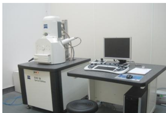
蔡司电子扫描电镜 SEM
