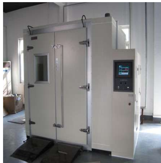
高温试验箱 high temperature test chamber
