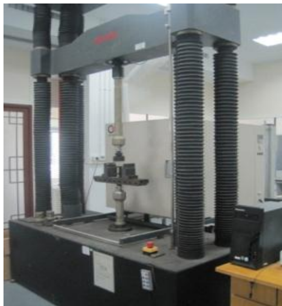
万能拉伸机 Universal Test Machine
